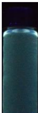
Abb. 6-9. Fluoreszenz von 10u nach Zugabe einiger Tropfen 1 M BBr 3 -Lösung in DCM (aufgenommen in DCM, T = 293 K, \lambda_{\text{exc}} = 365 \text{ nm} ).
