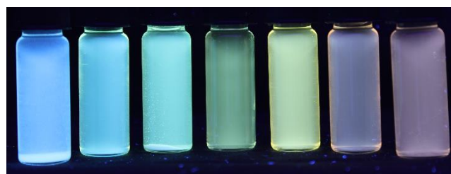
Abb. 5-18. Fluoreszenz von 4-(5-(4-(Dimethylamino)phenyl)-1-methyl-1H-pyrazol-3-yl)benzonnitril ( 10q ) mit zunehmender Lösungsmittelpolarität (von links nach rechts: Cyclohexan, Toluol, Ethylacetat, Dichlormethan, N,N -Dimethylformamid, Acetonitril; \lambda_{exc} = 365 \text{ nm} ).
