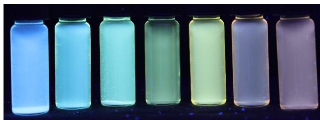
Abb. 2-1. Positive Emissionssolvatochromie von 4-(5-(4-(Dimethylamino)phenyl)-1-methyl-1 H -pyrazol-3-yl)benzonnitril ( 10q ).
